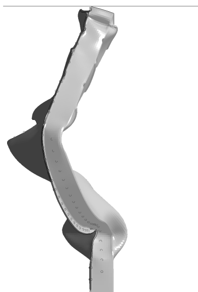
Figura 40: Flexão da viga principal em S com seção transversal usada pela Fiat em relação ao eixo vertical do veículo
